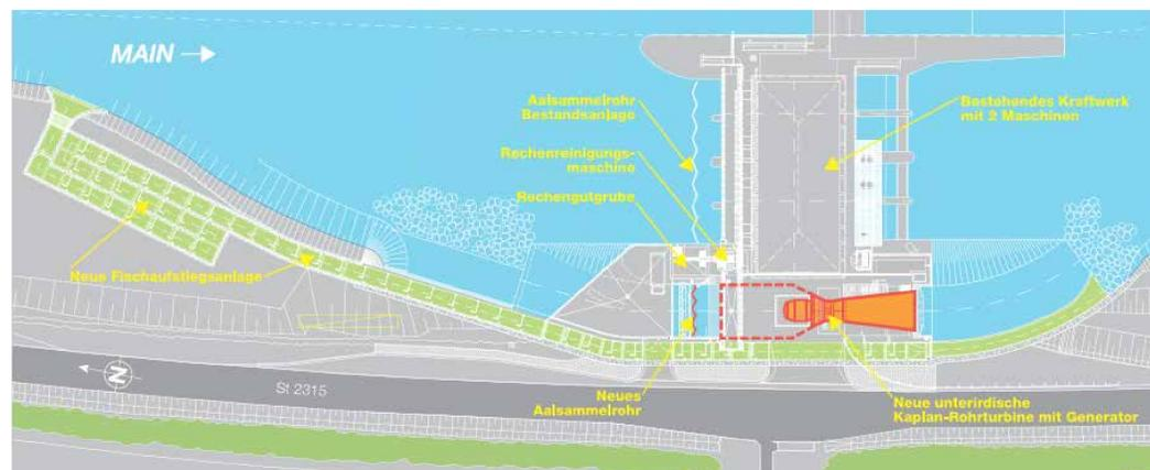
Litern Mainwasser (entspricht zwölf Badewannenfüllungen) pro Sekunde. Die Wasserzuführung in den Beckenfischpass wird automatisch so gesteuert, dass stets bestmögliche Wasserverhältnisse für die Zielfischarten Lachs, Barbe, Nase und Maifisch herrschen, wenn sie die Höhendifferenz von bis zu 5,2 m zwischen Turbinenauslauf (Unterwasser) und Turbinenzulauf (Oberwasser) überwinden.
